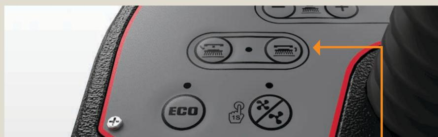
Повернуть главный ключ в положение «Вкл.» и нажать кнопку фиксации щётки. Дека опустится, медленно повернутся щётки до их фиксации.
