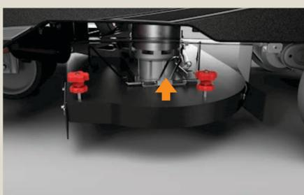
Щетка устанавливается вручную, либо автоматически. Для автоматической установки требуется надавить на металлическую ручку и разместить щетку под декой в соответствующее положение до упора о стержни, затем отпустить ручку. Установить на прежнее место боковую юбку.
