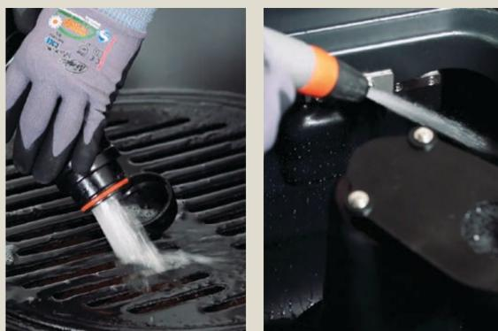
Опорожнить бак, используя расположенный в задней части шланг. Опорожнить и очистить лоток для мусора, промыть бак грязной воды.
