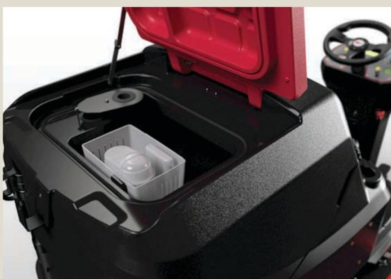
Оставить машину с открытой крышкой бака грязной воды.
