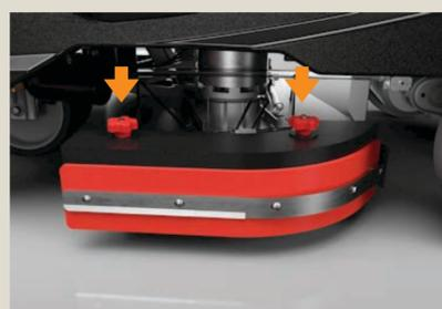
Освободить две ручки, чтобы снять боковую юбку.
