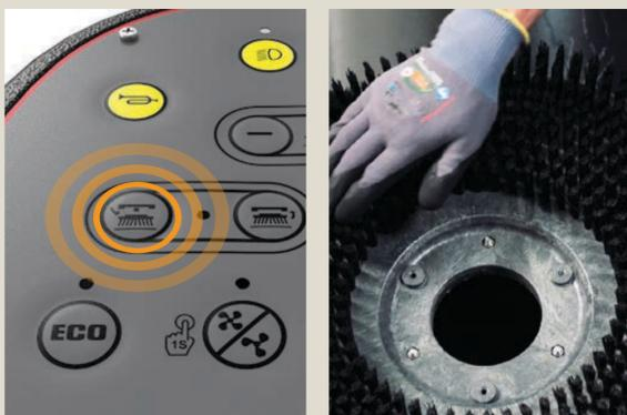
Когда ключ находится в положении «Вкл.», нажать кнопку снятия щётки, чтобы снять щётку/пэд для осмотра и очистки.
