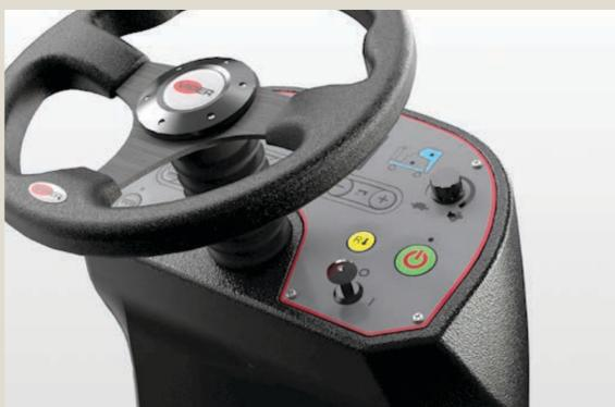
С помощью ключа отключить машину.
