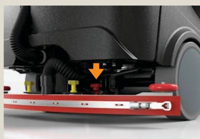
С помощью регулировочных винтов выставить угол скребка и давление лезвия, чтобы обеспечить эффективный сбор воды.
